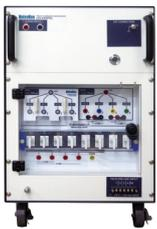
可进行 IEC61000-4-5 标准规定的针对非屏蔽对称互连线 / 通信线的浪涌试验。
