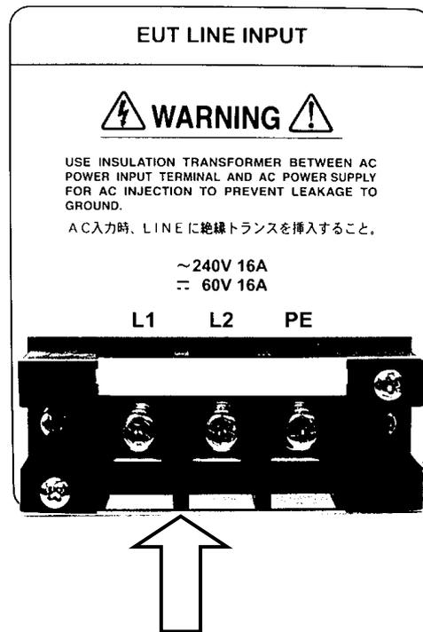
应准备好满足EUT电力容量的EUT用电源与电源供电电缆，该EUT LINE INPUT接线板和EUT用电源间请务必插入绝缘变压器。
