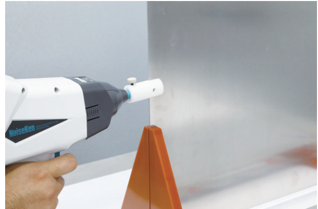
使用如图所示的导板可使放电更易操作。
